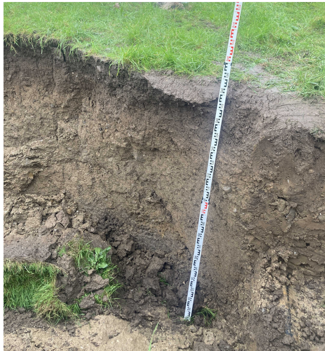
Sondagenschlitz 3 geplante Sohlenlage = -2.8m
