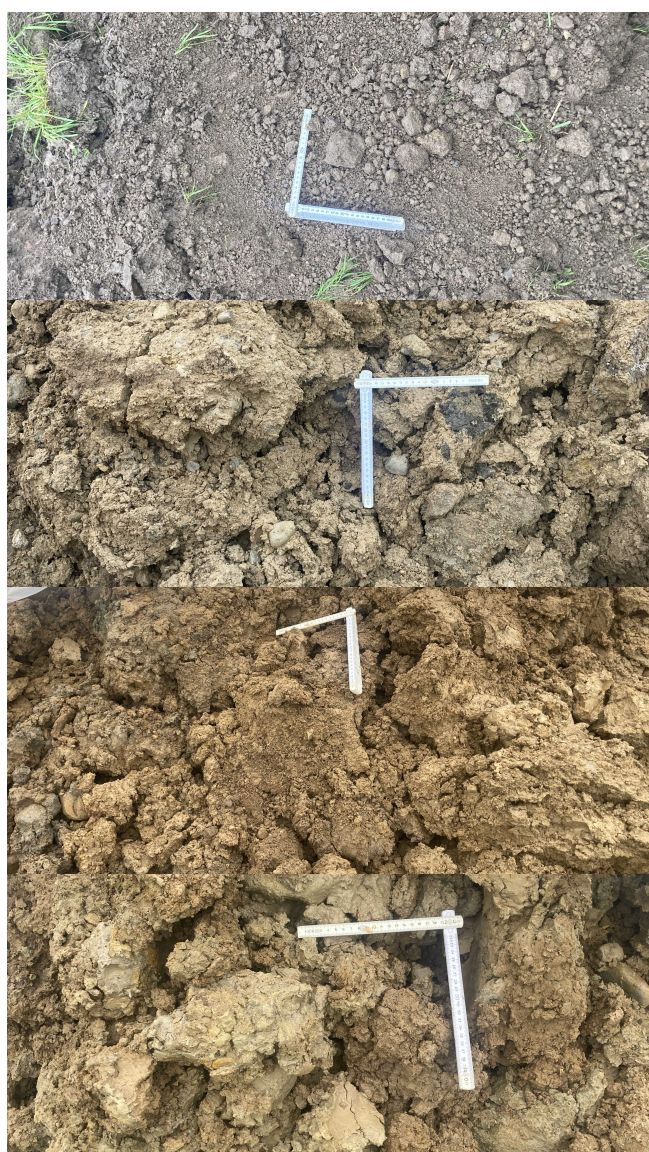
0-20cm Oberboden 20-50cm Unterboden 50-250cm sehr feines Material (Silt, Ton) wenig Steinen < 10cm
