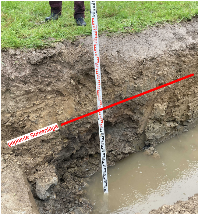
Sondagenschlitz 1 geplante Sohlenlage = -0.6m
