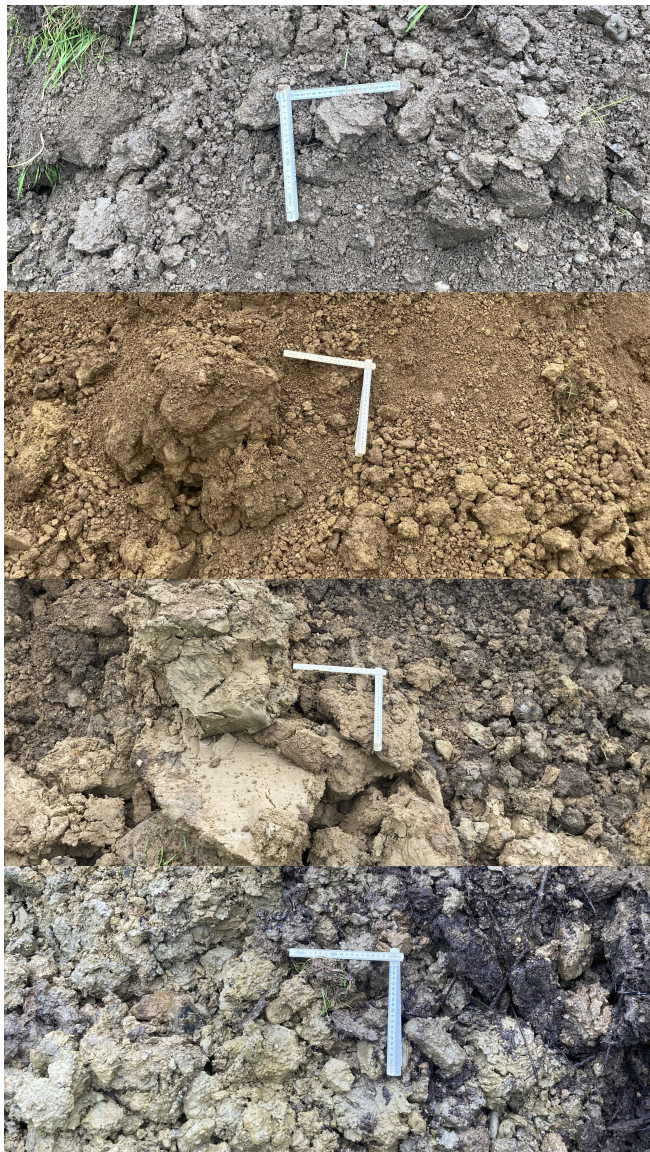
0-20cm Oberboden 20-50cm Unterboden 50-100cm sehr feines Material (Silt, Ton) 100-150cm sehr feines Material (Silt, Ton), wenig Steine d=ca. 5-10cm 150-200cm sehr feines Material (Silt, Ton), stellenweise organisches Material
