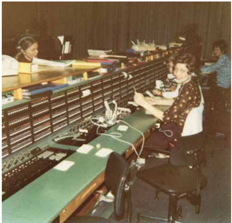
Manuelles «Stöpseln» von internationalen Verbindungen, 1973.
