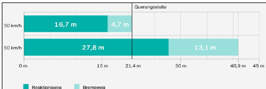
Abb. 7 Anhalteweg bei 30 km/h und 50 km/h bei trockener Fahrbahn [Quelle: bfu]
